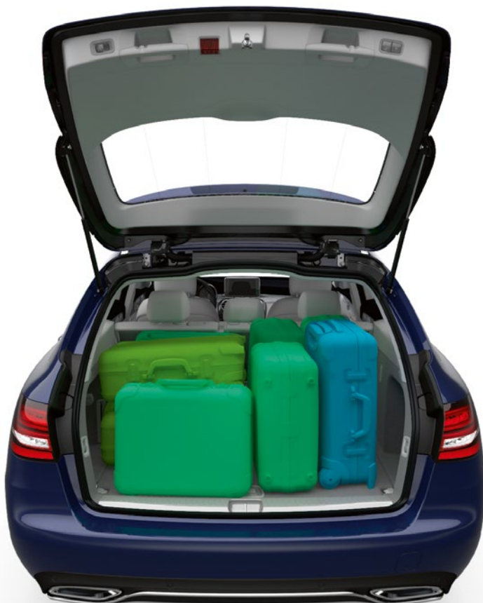
BILD 4 Packstudie mit einem Set von Koffern verschiedener Größe: die Anordnung der Koffer im Kofferraum erfolgt vollautomatisch (© Daimler)
