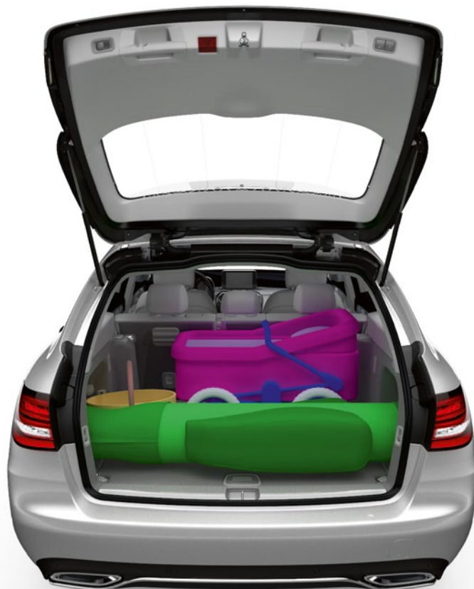
BILD 3 Packstudie mit verschiedenen Gegenständen: Der TrunkPacker findet automatisch die einzig mögliche Platzierung der grünen Golftasche unter Benutzung der seitlichen Mulden; für den braunen Einkaufskorb und pinkfarbenen Kinderwagen wird bei der Anordnung die Vorgabe eingehalten, dass diese aufrecht stehen sollen (© Daimler)
